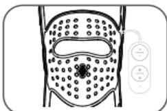
STEP 3: コントローラー上で、2秒間電源ボタンを長押しして電源を入れ、白いランプを点灯させます。
