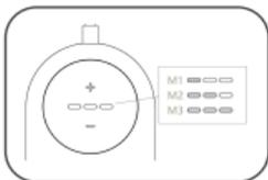
STEP 5: 3つのモードから適切なモードを選択し、「+」や「-」ボタンにて短押し調整します。
