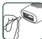
1. 照射口付近をメンテナンスする際は、電源プラグを抜き、対象部分が冷たくなったことを確認してから行ってください。(使用中とその直後は発熱しています)
